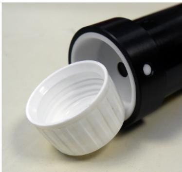
Nous concevons et fabriquons des accessoires sur mesure adoptant la forme exacte de vos bouchons. Ces accessoires sur mesure offre l'avantage de limiter tout glissement mais aussi de s'affranchir du serrage du bouchon par des doigts. Le bouchon est ainsi toujours maintenu de la même façon et non contraint lors de la rotation. Les mesures sont plus répétables et précises.
