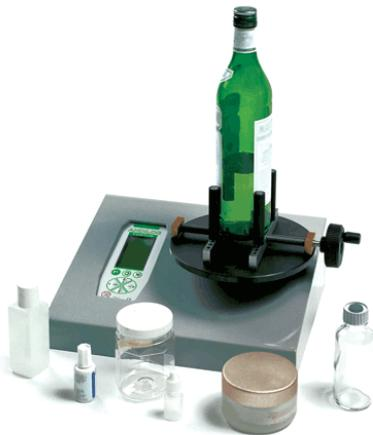
Les couplemètres Anditork ont été développés pour la mesure manuelle du couple de serrage et de desserrage des bouchons. Ils sont adaptés à une grande variété d'échantillons comme les bouteilles (eau, sirop, vin, spiritueux), les flacons (parfum, médicaux), les éprouvettes, les bocaux ou les pots par exemple.
